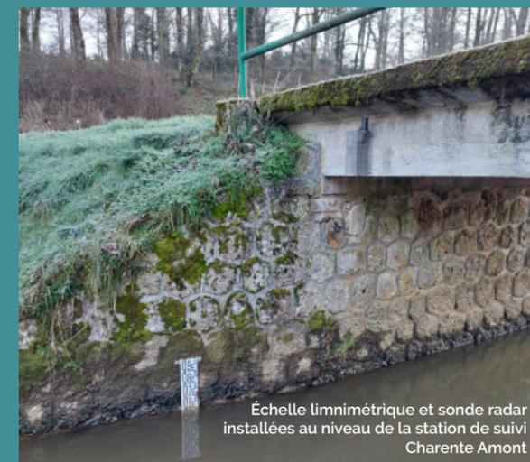
Échelle limnimétrique et sonde radar installées au niveau de la station de suivi Charente Amont
