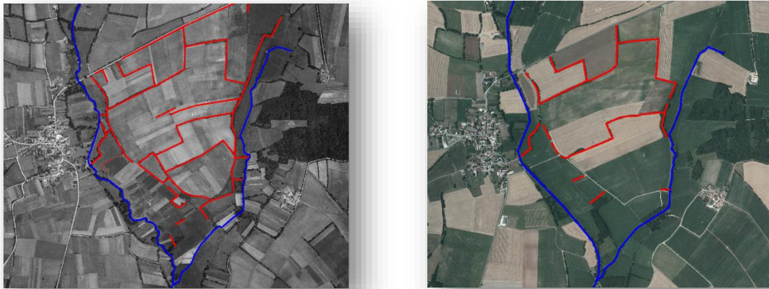
Figure 21 : Carte d'évolution du chevelu hydrographique (en bleu) entre 1950 et 2000 par rectification, recalibrage (sous-bassin de l'Aume-Couture) - © IGN
