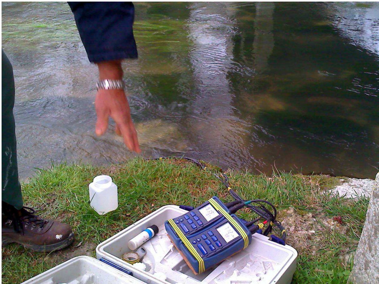
Mesures de paramètres in situ (sondes)
