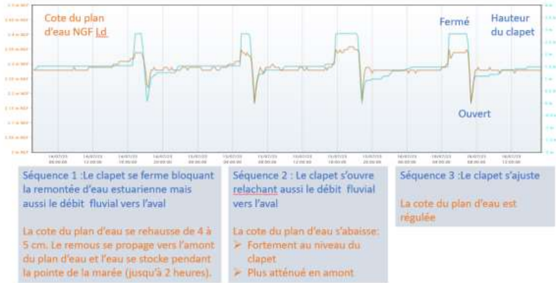
Figure 39 Séquençage des conséquences de la gestion hydraulique sur le niveau du plan d'eau amont
