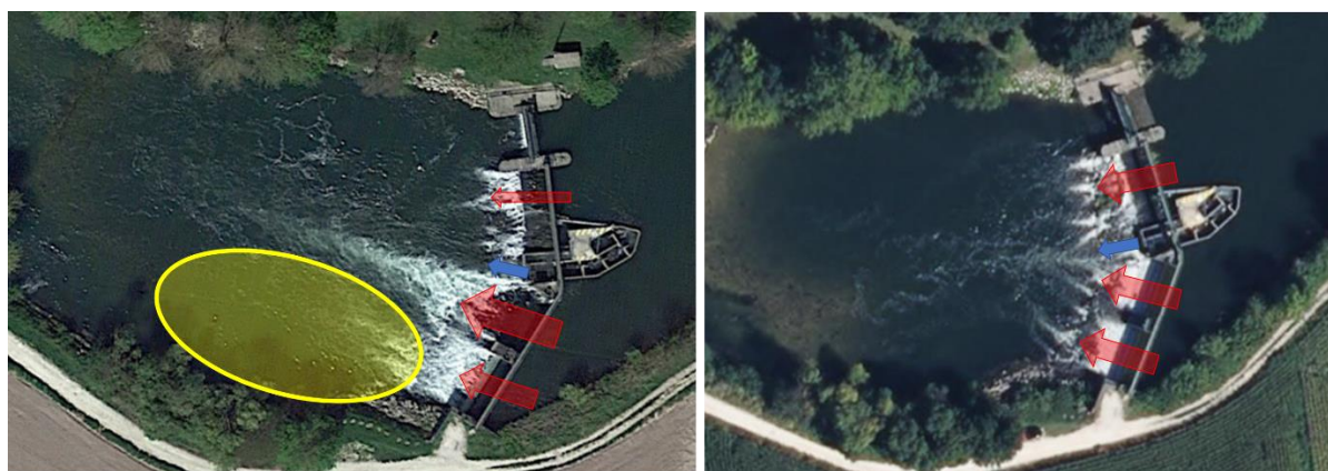
Figure 9 : Illustration des conditions d'accessibilité à la passe à poissons de Crouin dans 2 configurations contrastées de débit et de gestion des vannes. À gauche (06/04/17), la majorité du débit est restitué par la vanne centrale, générant un potentiel cloisonnement des aloses en rive gauche (cercle jaune). À droite (14/08/17), le débit est restitué de façon plus homogène entre les vannes, la détectabilité et l'accessibilité à la passe à poissons (flèche bleue) sont favorables pour les aloses.
